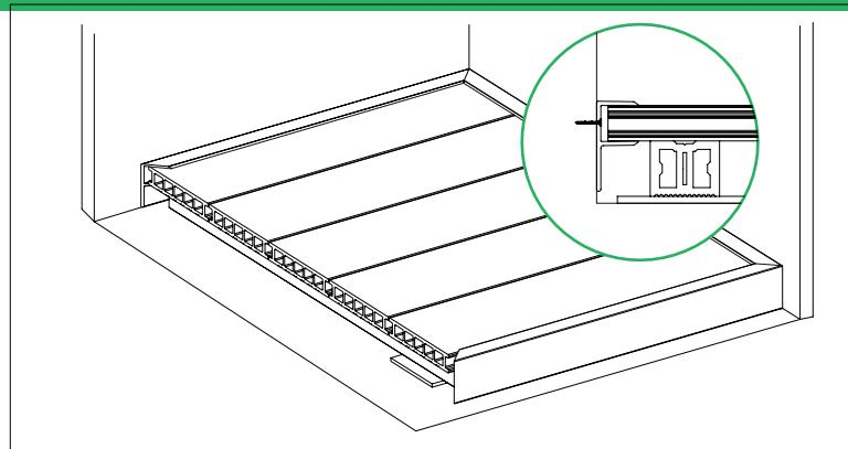
Вариант 2. Торцы настила закрываются при помощи уголка. Уголок крепится к каждой лаге в настиле на саморезы в предварительно просверленное отверстие на 1-1,2 мм большее, чем диаметр самореза.
