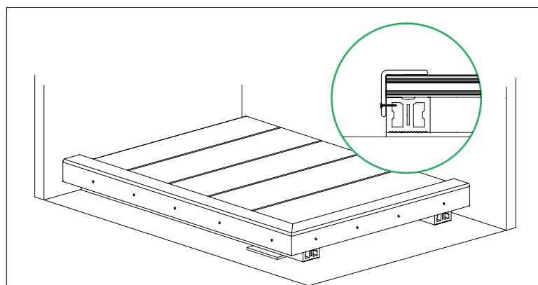
Вариант 3. Торцы настила закрываются при помощи торцевой рейки. Торцевая рейка крепится к каждой лаге на саморезы в предварительно просверленное отверстие на 1-1,2 мм большее, чем диаметр самореза.
