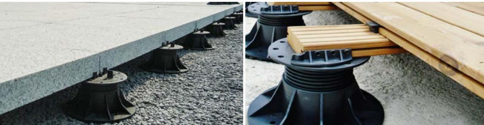
♻ Система опор SAVEWOOD используется для корректировки высот и выравнивания наклонных поверхностей при монтаже настилов, террас, подиумов, эксплуатируемой кровли. Опоры SAVEWOOD регулируются по высоте в диапазоне от 14 мм до 650 мм и могут быть использованы под различными строительными материалами (древесно-полимерный композит, дерево, плитка, гранит, стекло и т.д.). производство Armada Groupe, Турция.
